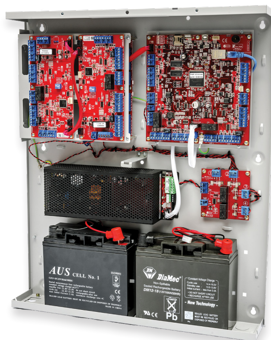
CI-DESSUS : IAC illustré en configuration 8 portes / 10 lecteurs. (IAC avec périphériques d'extension UniBus 2 portes / 2 lecteurs connectés). Logé dans le boîtier WideBody avec plaque à charnière, alimentation 8A, carte relais de déverrouillage porte coupe-feu et 2 batteries 17Ah
